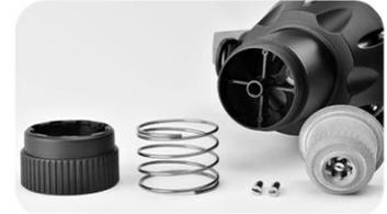
2. 用手拧开滤芯锁扣（旋转 90° ），取出过滤棉，更换干净的滤棉，关闭过滤器并锁定锁扣（旋转 90° ）。
